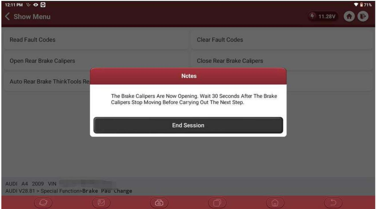
Paso 7: La bomba de freno se retrajo, sekecciona "OK" y realiza el remplazo de balatas
