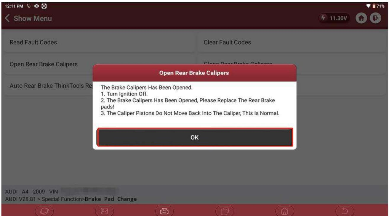
Paso 8: Después de reemplazar las balatas, selecciona "Cierre de calipers traseros"
